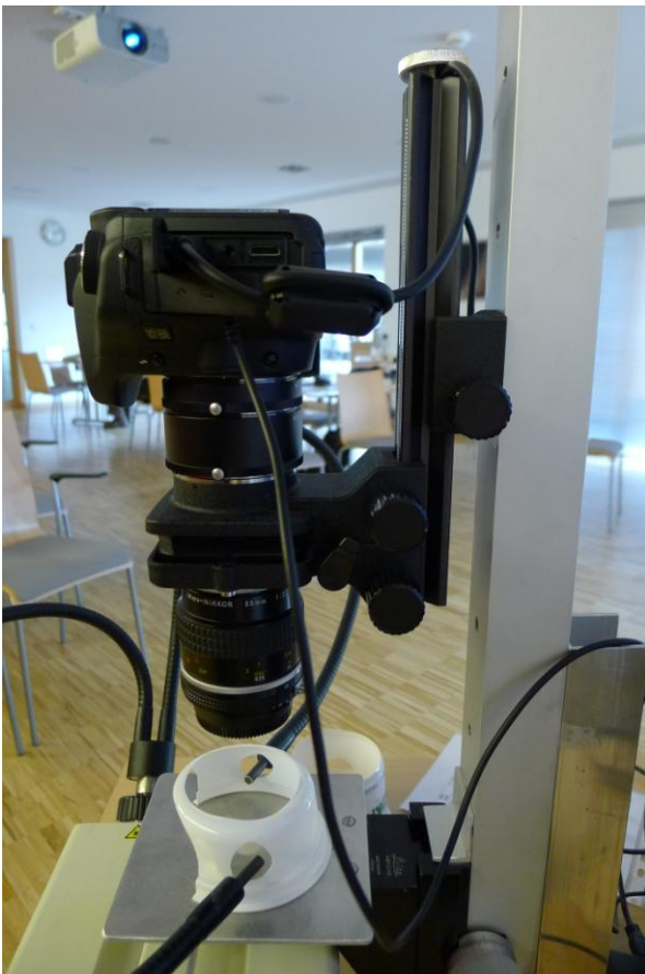
Abb. 1: Makro-Fotografieeinrichtung bestehend aus Stativ mit Feintrieb entlang der optischen Achse, Kamera, Balgengerät und Objektiv in Normal- oder Retrostellung.
