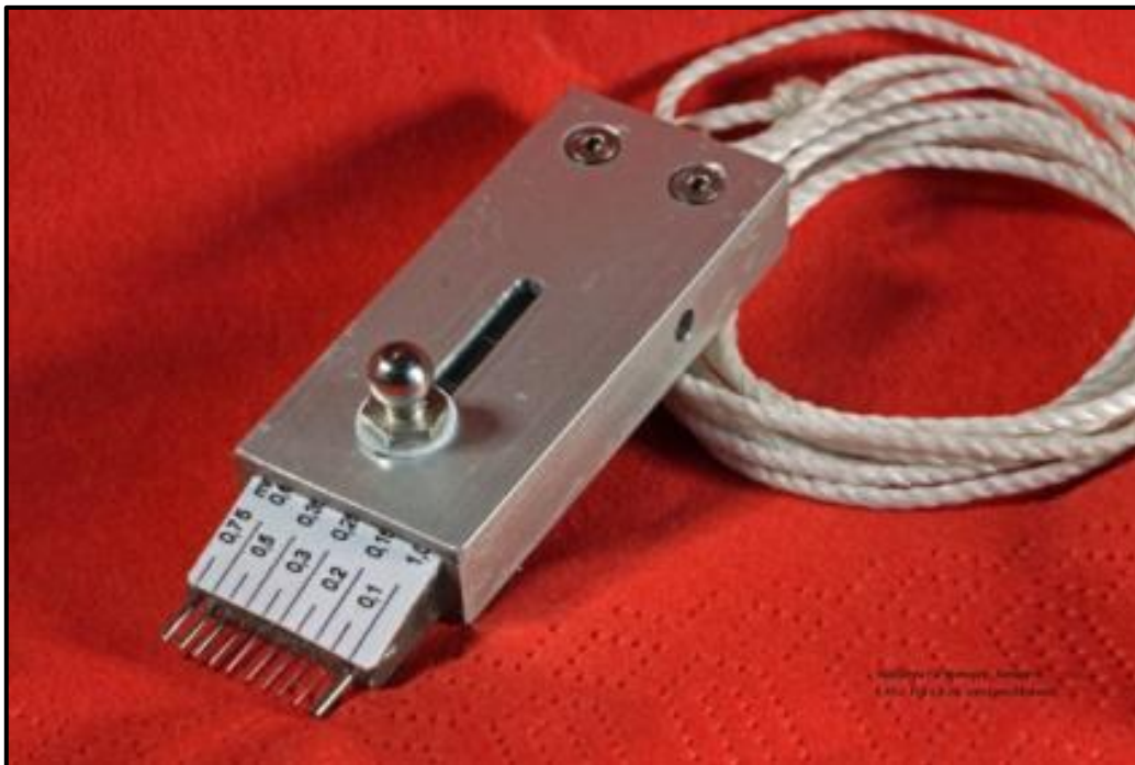
Abb. 1: Messlehre mit ausgefahrenem Schieber und Messsonden
